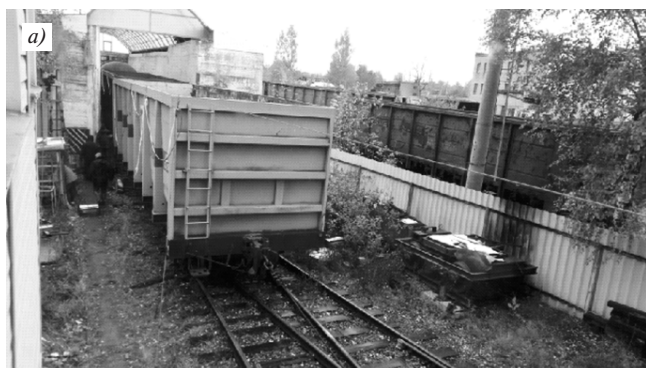
Рис. 12. Виды стенда-горки с вышки управления: а — ударный стенд; б — горка с тяговой установкой в конце
