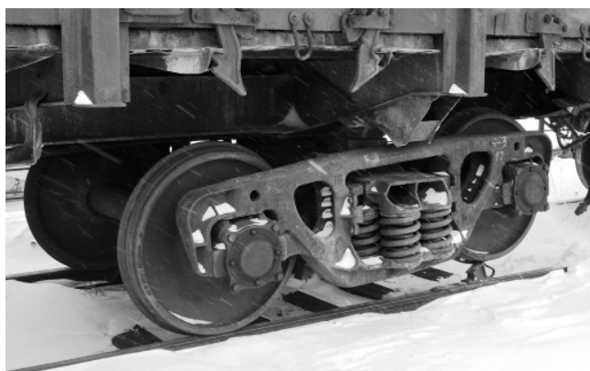
Рис. 8. Момент перекатывания колеса через упорную колодку башмака
