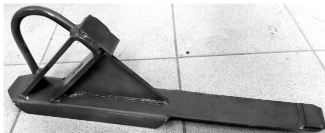
Рис. 17. Стояночный башмак по ТТ БТС-ВНИИЖТ-2015, чертеж ТМ 37.01.16—01 СБ
