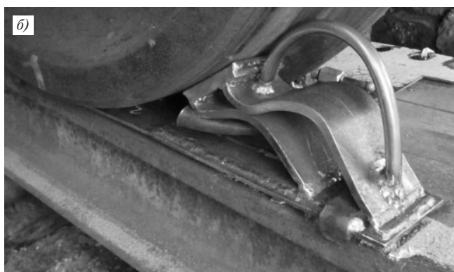
Рис. 15. Характер повреждений при вкатывании колеса на упорную колодку:
