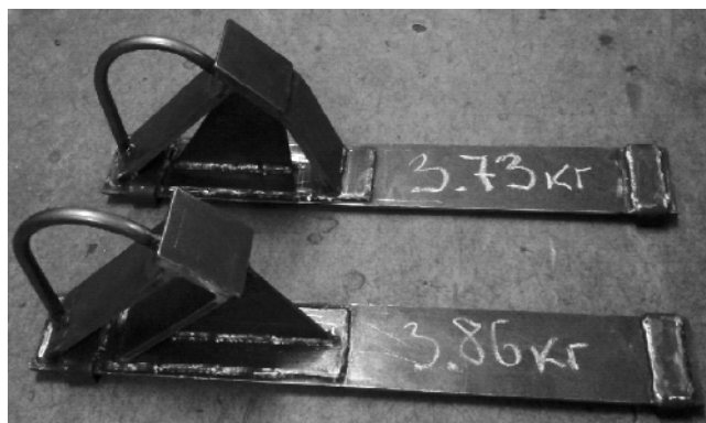
Рис. 11. Внешний вид опытных образцов тормозных стояночных башмаков для предварительных испытаний
