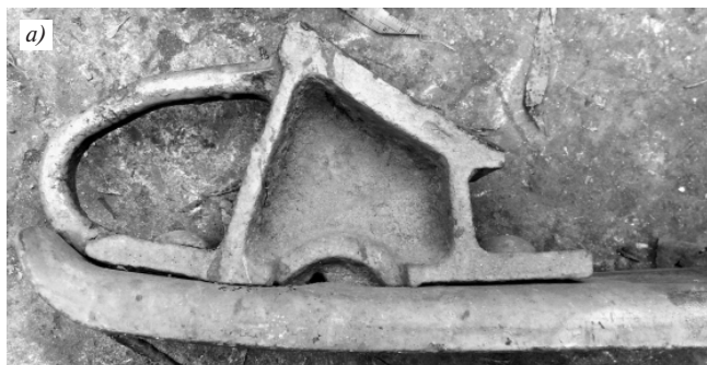
Рис. 17. Стояночный башмак по ТТ БТС-ВНИИЖТ-2015, чертеж ТМ 37.01.16—01 СБ
