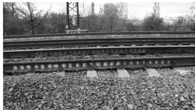
Рис. 2. Общий вид измерительного участка для исследования ударных сил взаимодействия колес с дефектами и рельсов Fig. 2. General view of the measuring section for research of impact forces interaction of the wheels and rails with defects
