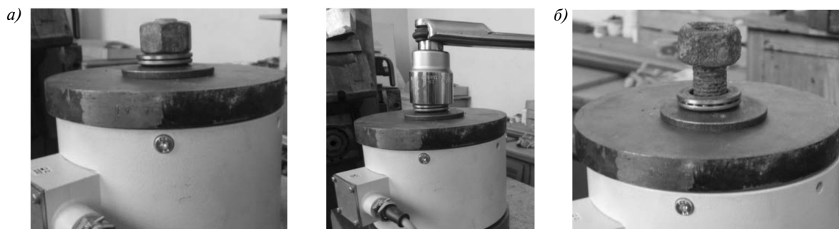
Рис. 7. Испытание на определение коэффициента закручивания: а — болт с гайкой с термодиффузионным покрытием «Левикор»; б — болт с гайкой без антикоррозионного покрытия Fig. 7. Test to determine the friction coefficient: а — bolt with a nut with thermal diffusion coating "Levikor"; б — bolt with a nut without anti-corrosion coating
