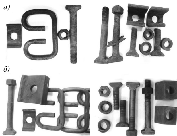
Рис. 8. Элементы скрепления пути после пропуска 30 млн т брутто: а — элементы скрепления без антикоррозионного покрытия; б — элементы скрепления с термодиффузионным покрытием «Левикор»
