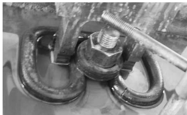
Рис. 2. Испытание на циклическую долговечность с подачей коррозионной среды
