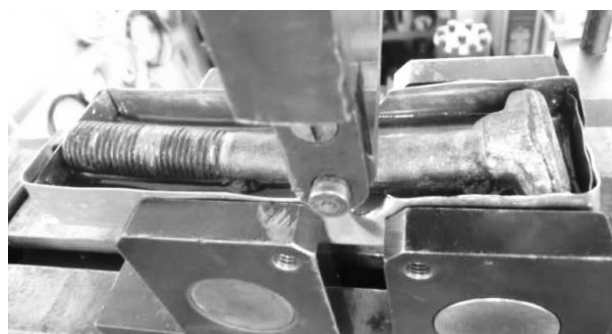
Рис. 4. Испытание на трехточечный изгиб закладного болта с подведением коррозионной среды Fig. 4. Three-point bending testing of embedded bolts with supplying the corrosive environment
