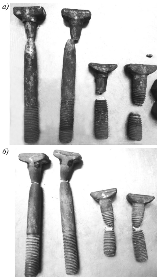
Рис. 3. Внешний вид клеммных и закладных болтов после испытания на разрыв: а — без покрытия; б — с антикоррозионным покрытием «Левикор» Fig. 3. Exterior view of clamp and embedded bolts after the tensile test: а — uncoated; б — with anticorrosion coating "Levikor"
