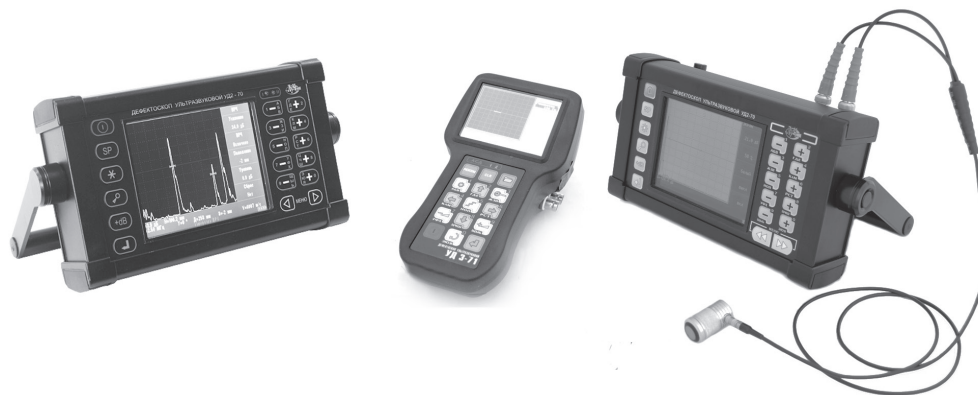
Рис. 1. Ультразвуковые импульсные дефектоскопы (слева направо): УД 4-76, УД 3-71, УД 2-70 Fig 1. Ultrasonic pulse flaw detectors (from left to right): UD 4-76, UD 3-71, UD 2-70
