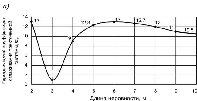
жения пути по трем или четырем точкам. Система выправки с измерением положения пути по трем точкам широко распространена на Российских железных дорогах и применяется, в частности, в путевых машинах ВПО-3000, ВПО-3-3000, ВПО-3-3000С, а также может применяться при рихтовке машинами ВПР-02М и ВПРС-02 при постановке в проектное положение отдельных точек и сглаживании отрезков пути между ними.
