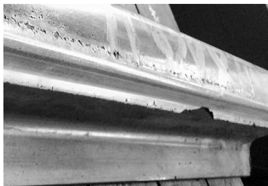
Рис. 6. Выкол металла головки рельса партии ДТ2.2 Fig. 6. Metal indent of rail head of the batch DT2.2
