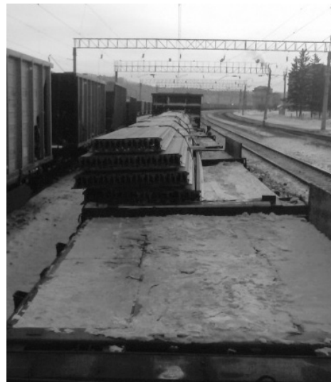
Рис. 5. Пример нарушения крепления груза со сдвигом в поперечном направлении
