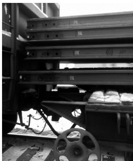
Рис. 4. Пример нарушения крепления груза со сдвигом в продольном направлении Fig. 4. An example of violation of fastening the goods with a shift in the longitudinal direction
