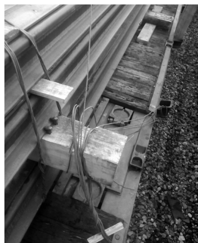
Рис. 1. Крепление деревянного бруска к полу вагона при перевозке рельсов Fig. 1. Fastening of a wooden block to the floor of the car when carrying rails
