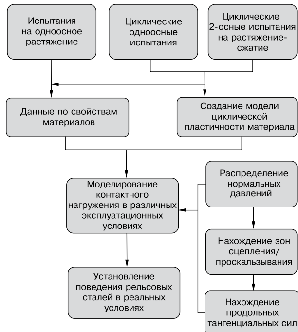
Рис. 10. Блок-схема модели прогнозирования возникновения КУП рельса в зоне сварного стыка [23] Fig. 10. Scheme of welded joint rolling contact fatigue initiation [23]
