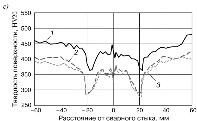
Рис. 9. Зона сварного стыка (а), излом рельса от поперечной трещины, развившейся от поверхностной трещины в зоне выкружки головки рельса (б), изменение твердости поверхности рельса в зоне стыка (с) [23]:
