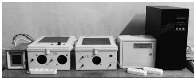
Рис. 2. Комплект оборудования для передачи электроэнергии в резонансном режиме
