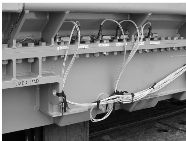
Рис. 9. Измерительные схемы от тензорезисторов для подключения к регистрирующей аппаратуре, показанной на рис. 10
