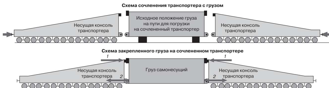
Рис. 8. Принцип размещения и крепления груза, подлежащего перевозке на сочленном транспортере. Силы, удерживающие груз от падения на путь: 1 — сжимающие; 2 — растягивающие
