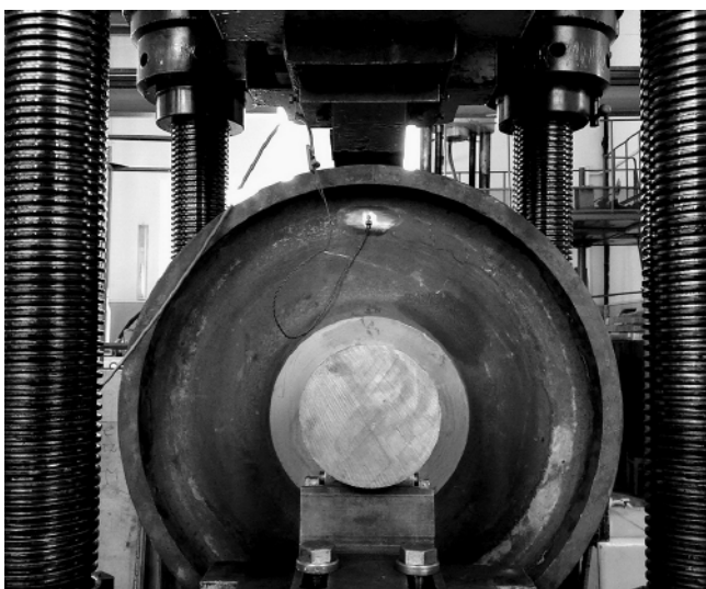
Рис. 6. Стендовое усталостное испытание катаного центра с проведением тензометрирования наиболее нагруженных зон
