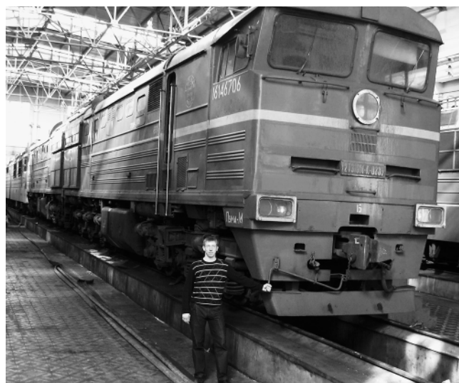
Рис. 7. Грузовой тепловоз 2ТЭ10МК № 335 с катаными колесными центрами (Экспериментальное кольцо, ст. Щербинка)
