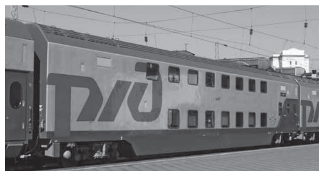
Рис. 10. Двухуровневые пассажирские вагоны габарита T_{пр} Fig. 10. Double-decked passenger cars for T_{пр} loading gauge
