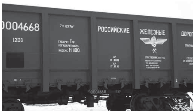
Рис. 7. Полувагон габарита T_{пр} Fig. 7. Open car for the loading gauge T_{пр}
