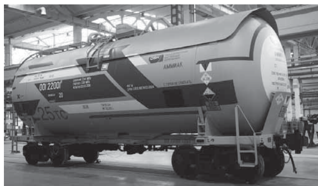
Рис. 8. Цистерна габарита T_{пр} для перевозки аммиака Fig. 8. Tank for T_{пр} loading gauge for ammonia transportation
