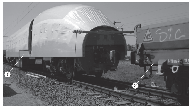
Рис. 3. Испытания на соударения: 1 — головной вагон электропоезда «Сапсан»; 2 — вагон-боек Fig. 3. Impact tests: 1 — head car of the Sapsan EMU train; 2 — car striker
