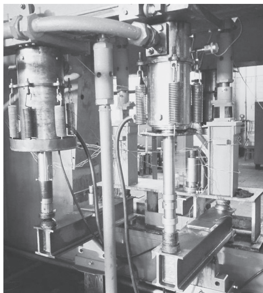
Рис. 1. Стенд для проведения вибрационных испытаний типовых образцов сварных балок Fig. 1. Stand for vibration testing of type samples of welded beams
