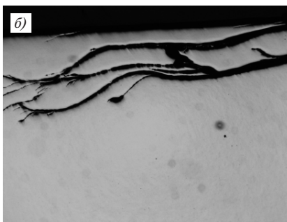
Рис. 6. Разновидности поверхностных трещин контактной усталости в головке объемно-закаленного рельса (продольные шлифы без травления, \times 12 )
