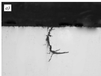
Рис. 6. Разновидности поверхностных трещин контактной усталости в головке объемно-закаленного рельса (продольные шлифы без травления, \times 12 )
