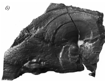
Рис. 3. Развитие продольной трещины в головке рельса от поверхности катания: а — вид сверху на головку рельса после отделения части металла (стрелками указан фрагмент («островок») поверхности катания); б — вид снизу на отделившуюся часть головки
