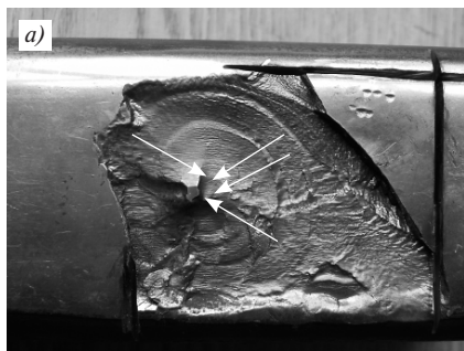
Рис. 3. Развитие продольной трещины в головке рельса от поверхности катания: а — вид сверху на головку рельса после отделения части металла (стрелками указан фрагмент («островок») поверхности катания); б — вид снизу на отделившуюся часть головки
