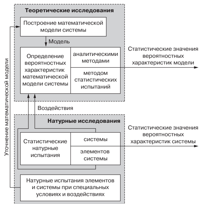
Рис. 1. Схема исследования при определении вероятностных характеристик
