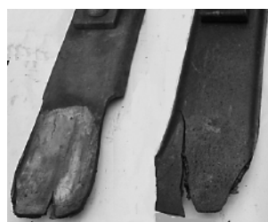
Рис. 3. Сравнение особенностей развития трещин в носках опытного (слева) и серийного (справа) башмаков
