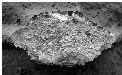
Рис. 6. Излом ручки башмака с зонами усталостного и хрупкого разрушения
