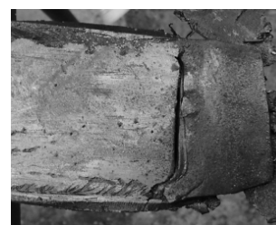
Рис. 4. Отрыв носка полоза из-за непрочной сварки переднего края накладки
