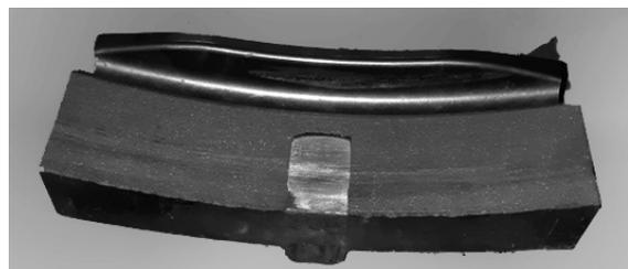
Рис. 1. Общий вид гребневой тормозной композиционной колодки UR 01-01 с чугунной вставкой
