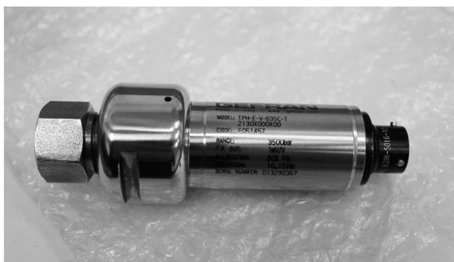
Рис. 3. Датчик давления Gefran
