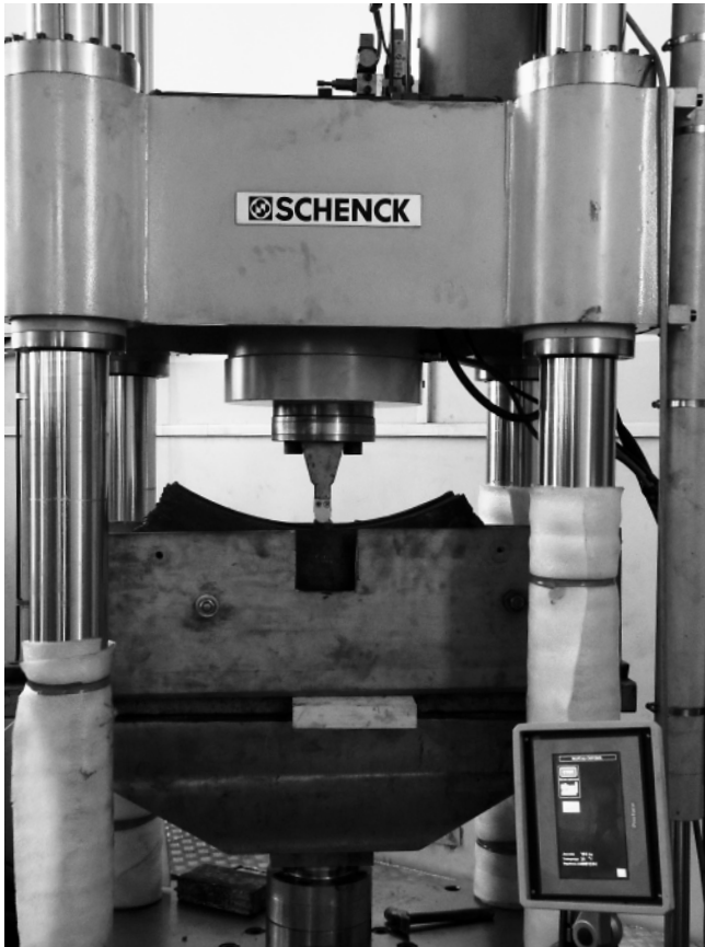
Рис. 4. Испытание сегмента бандажа на живучесть
