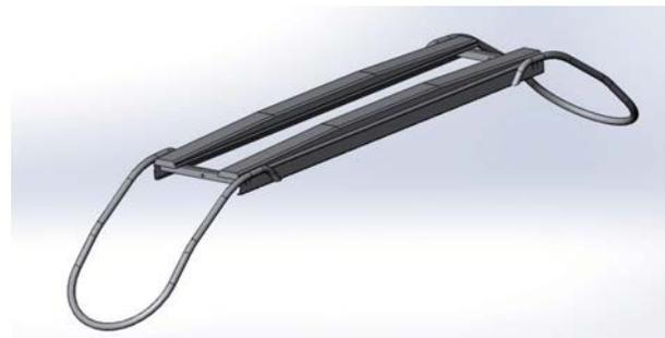
Рис. 4. Внешний вид изолированного полоза токоприемника упрощенной сборки для моделирования
