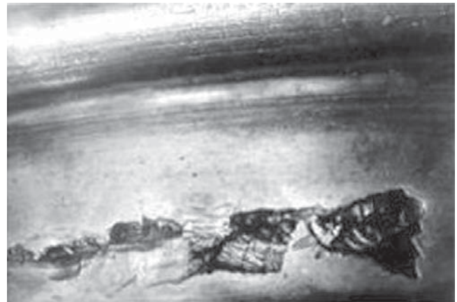
Рис. 3. Фрагмент бандажа КП электровоза с дефектом в виде вырыва металла на поверхности катания
