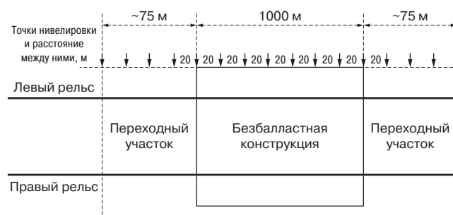
Рис. 17. Схема нивелировки опытного участка пути на перегоне Тосно — Саблино, 2-й главный путь
