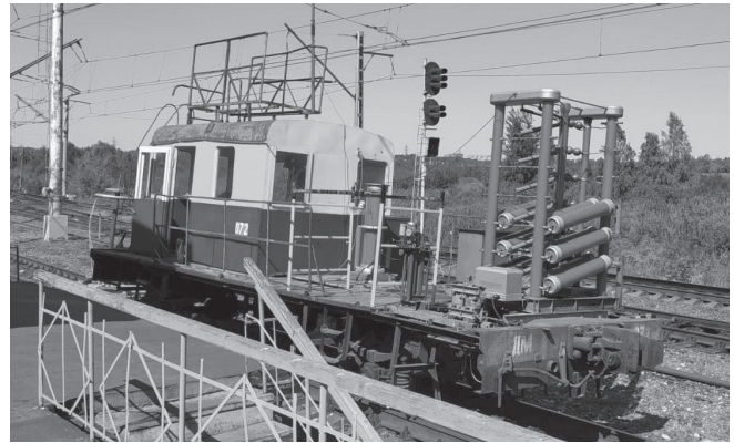
Рис. 1. Мобильная платформа со смонтированным оборудованием для проведения испытаний
