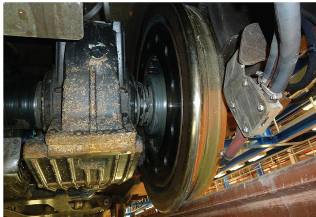
Рис. 1. Разрушения окраски корпуса редуктора из-за ударного воздействия щебня
