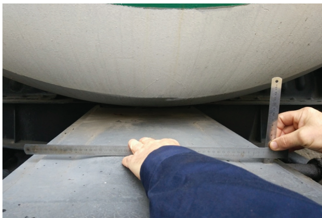
Рис. 1. Деформация верхнего листа хребтовой балки
