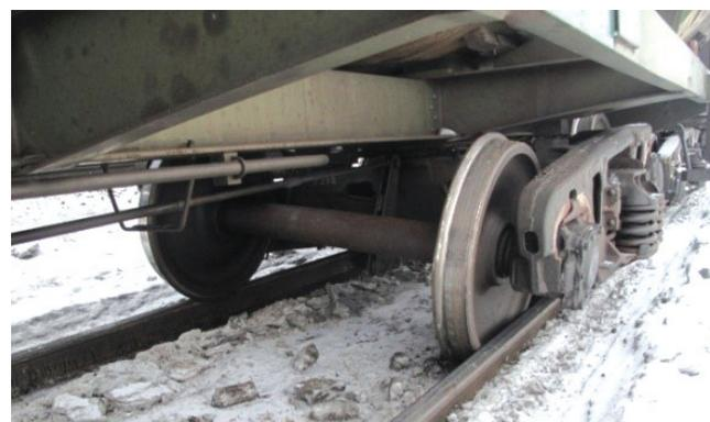
Рис. 2. Случаи проваливания колеса внутрь колеи
