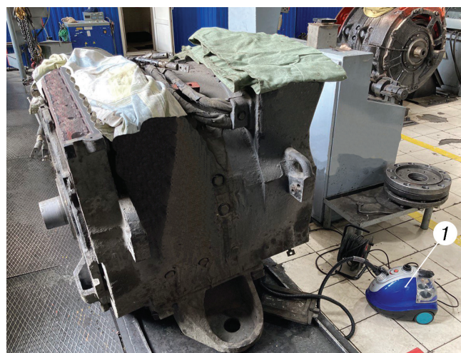
Рис. 3. ТЭД типа ДПТ-810 № 2032 в процессе его увлажнения: 1 — отпариватель-парогенератор типа Grand Master
