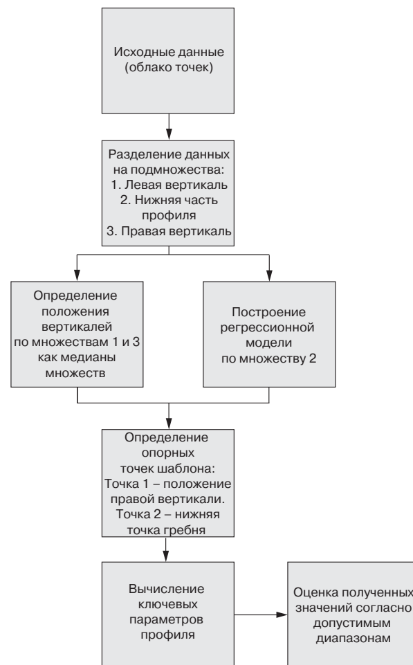
Рис. 4. Структурная схема оценки параметров профиля колеса
