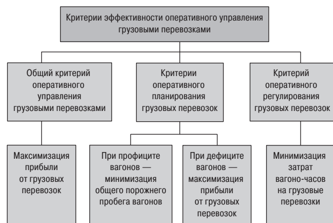
Рис. 3. Классификация критериев эффективности для оперативного управления грузовыми перевозками Fig. 3. Classification of performance criteria for operational management of freight transport
