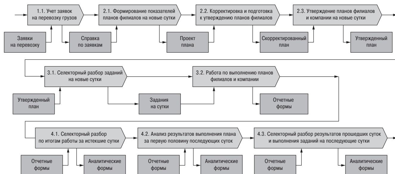
Рис. 5. Цикл бизнес-процессов оперативного управления перевозками Fig. 5. Business process cycle of operational traffic management
