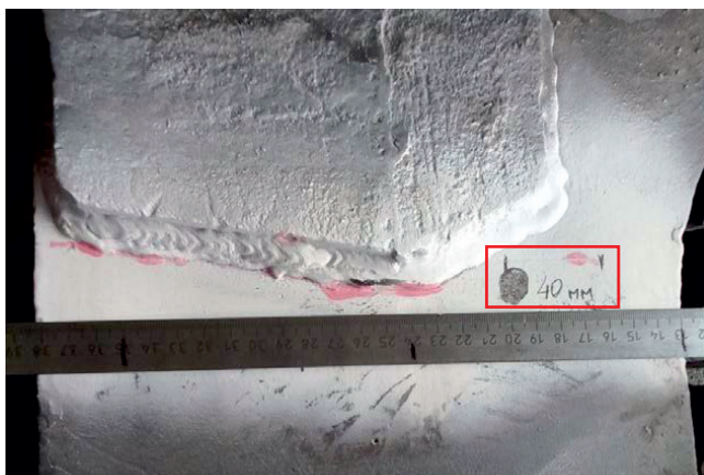
Рис. 7. Трещина № 1 после завершения испытаний
