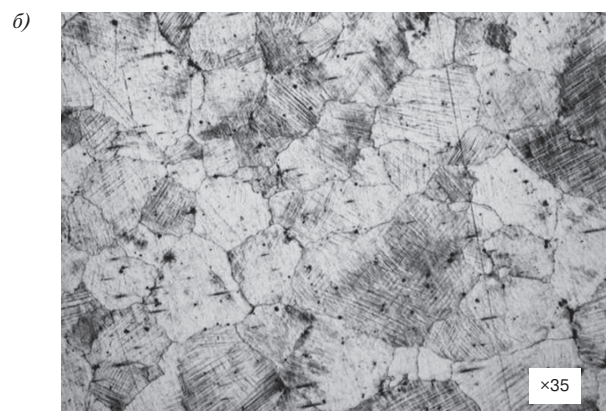
Рис. 9. Структура аустенита с полосами сдвига: а — на поверхности; б — на глубине 25 мм
