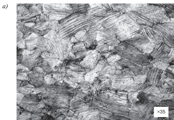
Рис. 9. Структура аустенита с полосами сдвига: а — на поверхности; б — на глубине 25 мм
