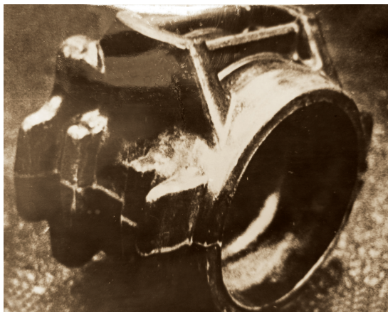
Рис. 4. Штампованная заготовка для корпуса буксы
