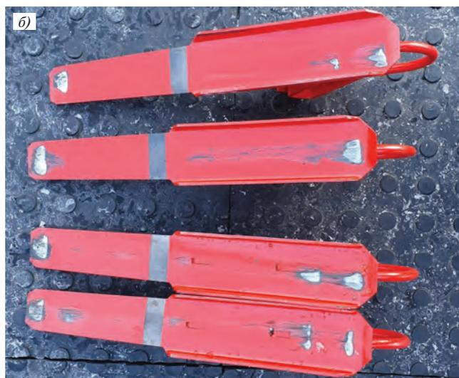
Рис. 8. Сдираание краски с окрашенных полозьев стояночных башмаков:
