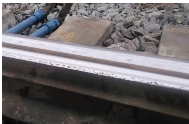
Рис. 3. Выкрашивание металла на рабочей поверхности острья типа Р65 из-за воздействия колес с повышенной нагрузкой
