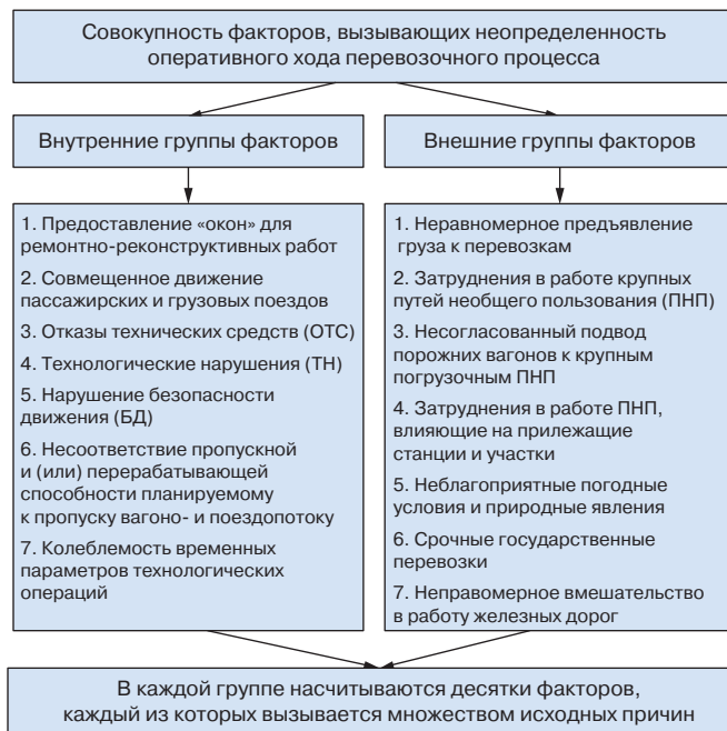
Рис. 2. Внутренние и внешние факторы, вызывающие неопределенность функционирования системы «перевозочный процесс в оперативном режиме работы»
