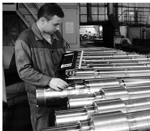
Рис. 2. Процесс ультразвукового контроля локомотивной оси с цилиндрической поверхности в радиальном направлении Fig. 2. Process of ultrasonic inspection of locomotive axis with the cylindrical surface in the radial direction
