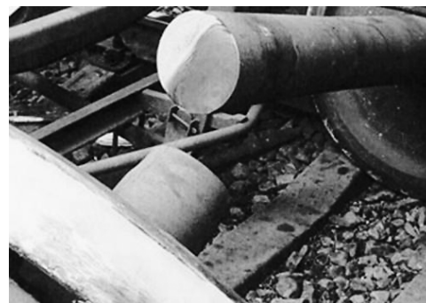
Рис. 1. Фото излома оси колесной пары грузового вагона Fig. 1. Pictures of axle breakage of freight cars
