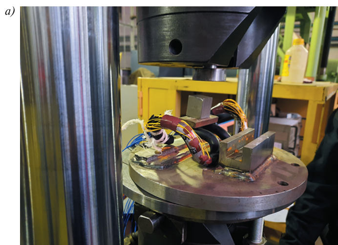
Рис. 8. Стендовые испытания упругой клеммы на универсальной машине для испытаний материалов ИК-100.01М*: а) установленная в ложементе клемма, оборудованная тензорезисторами для измерения напряжений кручения и изгиба; б) процесс нагружения клеммы вертикальной силой и перемещения центральной петли упругой клеммы * Источник: фото авторов
