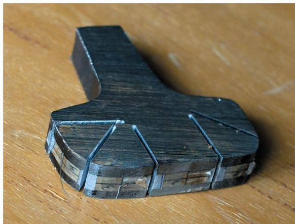
Рис. 8. Срез с поперечными тензорезисторами с вырезами\*
