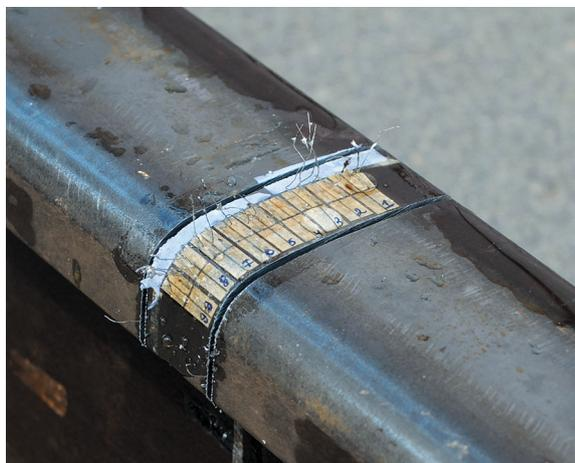
Рис. 5. Расположение продольных тензорезисторов\*
