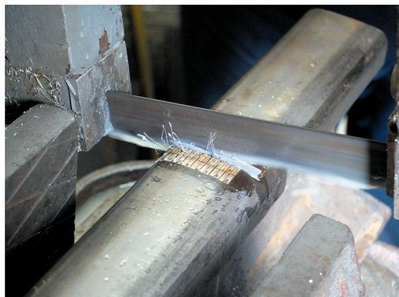
Рис. 7. Выполнение поперечного разреза рельса ленточной пилой\*
