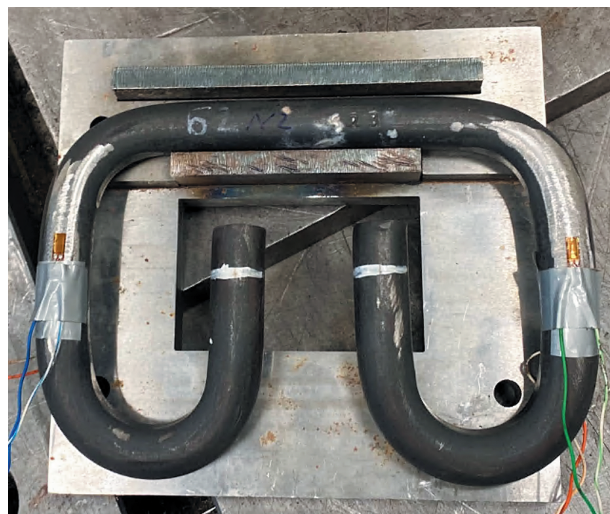
Рис. 3. Фото клеммы с наклеенными тензорезисторами (вид сверху)*
