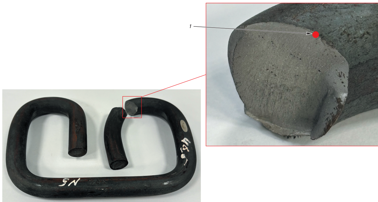
Рис. 7. Вид усталостного излома № 2 (вид на клемму сверху)*:
