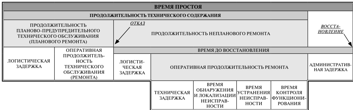
Рис. 1. Составляющие продолжительности технического содержания по ГОСТ 32192–2013 [15]
