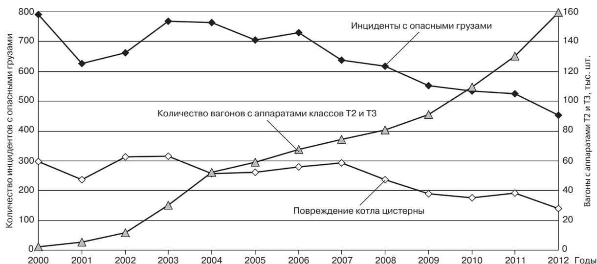
Рис. 4. Изменение количества инцидентов с вагонами для перевозки опасных грузов
