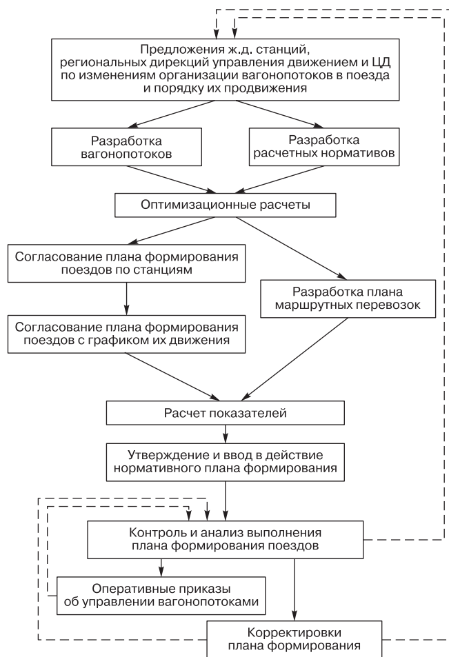
Рис. 1. Порядок разработки, ввода в действие и выполнения (жизненный цикл) плана формирования грузовых поездов* * Источник: данные авторов
