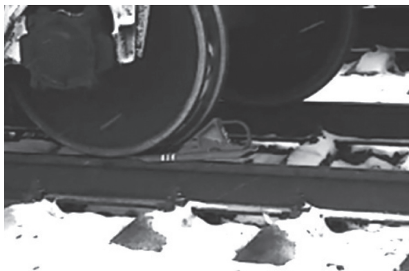
Рис. 6. Подскок серийного башмака при наезде колеса на загнутый носок полоза, зафиксированный стоп-кадром Fig. 6. Bounce of the serial shoe when the wheel hits the twisted skid end, caught with a stop-frame
