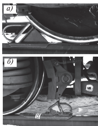
Рис. 8. Новый башмак с измененной ручкой (а) и серийный башмак (б) под вагоном-термосом с немецким нажимным башмаком и удлиненной чекой Fig. 8. A new shoe with a modified handle (a) and a serial shoe (b) under the thermos wagon with a German pressure shoe and an elongated check. Comparative characteristics of the new and standard shoes
