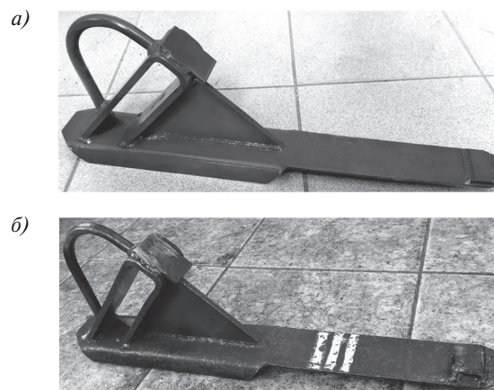
Рис. 1. Тормозной стояночный башмак установочной серии до эксплуатации (а) и после 6 месяцев интенсивной эксплуатации (б) Fig. 1. The parking brake shoe of the pilot batch before (a) and after 6 months of intensive operation (b)
