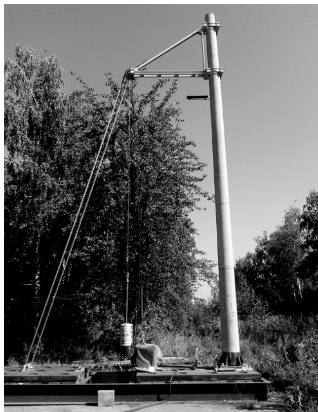
Рис. 1. Стенд вибрационного нагружения стоек Fig. 1. Stand for vibration loading of racks
