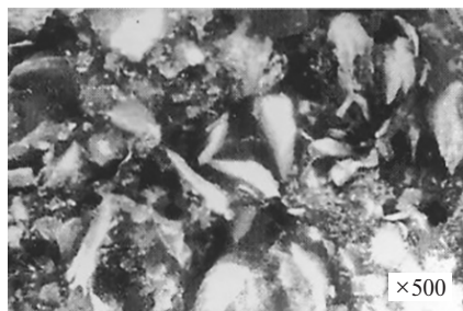
Рис. 1. Рельефная структура углеродного материала в донной части кратера после воздействия электрической дуги Fig. 1. Relief structure of the carbon material in the bottom part of the crater after exposure to the electrical arc
