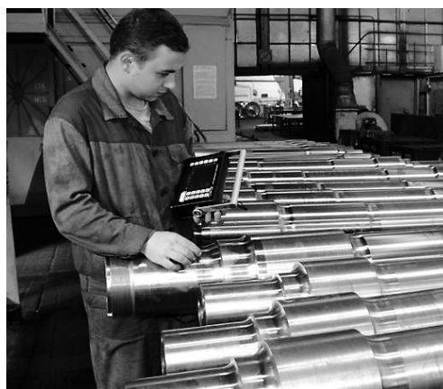
Рис. 2. Процесс ультразвукового контроля локомотивной оси с цилиндрической поверхности в радиальном направлении
