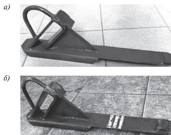
Рис. 1. Тормозной стояночный башмак установочной серии до эксплуатации (а) и после 6 месяцев интенсивной эксплуатации (б)
