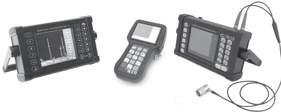
Рис. 1. Ультразвуковые импульсные дефектоскопы (слева направо): УД 4-76, УД 3-71, УД 2-70
