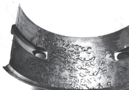
Рис. 1. Усталостные повреждения баббитового слоя в шатунном подшипнике дизеля 10Д100
