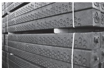
Рис. 3. Композитные шпалы из переработанного полиэтилена высокой плотности
