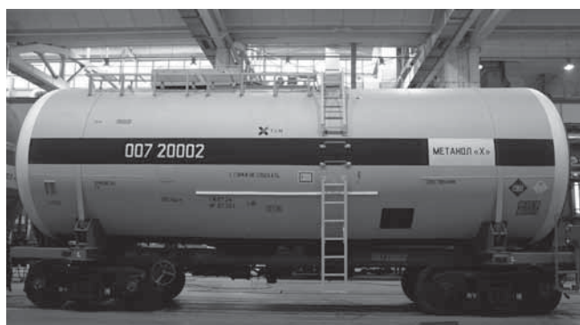
Рис. 9. Цистерна габарита Т пр для перевозки метанола Fig. 9. Tank for Т пр loading gauge for methanol transportation
