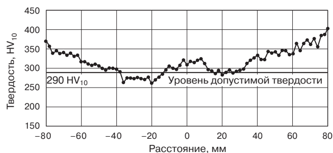
Рис. 4. Распределение твердости в головке рельса на продольном темплекте, вырезанном через сварной стык, полученный электроконтактной сваркой, после локальной термической обработки без достаточно интенсивного охлаждения
